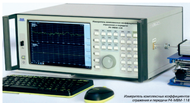
Измеритель комплексных коэффициентов и отражения Р4-МВМ-118, разработанный и изготовленный в БГУИР (из презентации Алексея Волынца)
