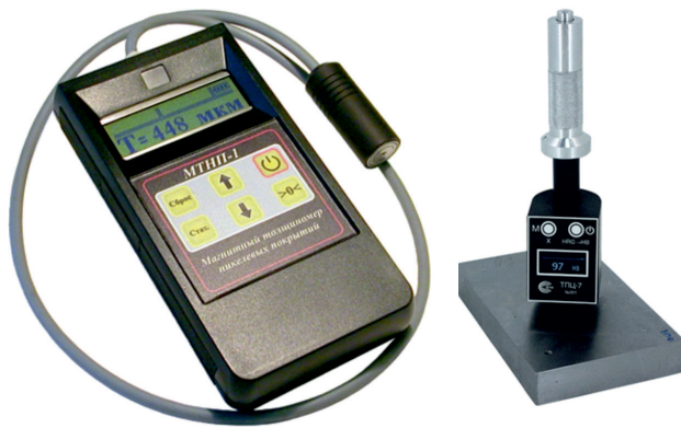
Магнитный толщиномер никелевых покрытий МТНП-1 (слева) и портативный твердомер ТПЦ-7 (справа), разработанные и изготовленные в ИПФ НАН Беларуси (из презентации Николая Грецкого)
