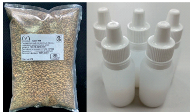
Государственный стандартный образец содержания массовой доли влаги в ячмене ГСО РБ 3273-2020 (слева) и стандартные образцы размера частиц на основе стабилизированных коллоидных растворов полистирола в воде (справа), изготовленные в БелГИМ (из презентации Дмитрия Ивашенко)
