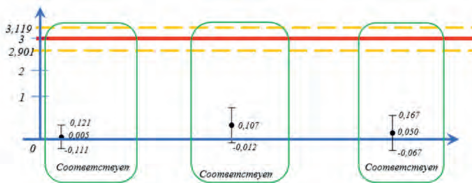
Рис. 4. График принятия решений по результатам калибровки газоанализатора «Автотест 02.02»
