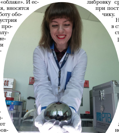
Кремниевая сфера, изготовленная с учетом нового определения единицы массы. Ведущий инженер Екатерина Коничева.
