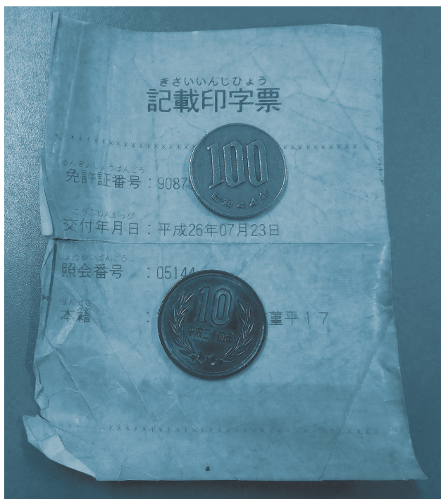
Рис. 2. «Долговременное хранение»: Квитанция с термопечатью, которая со временем может стать трудночитаемой
